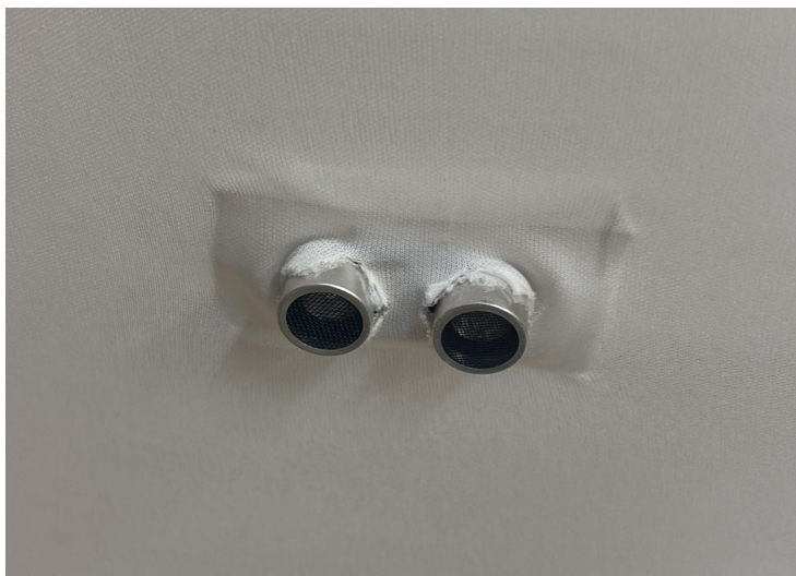
Foto de um dos sensores de proximidade montado na estrutura de tecido.
