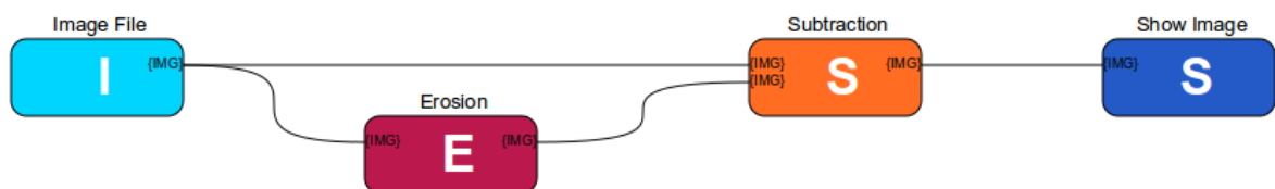
Figura 8 – Diagrama realizando uma subtração de imagens criado através da extensão OpenCV.
