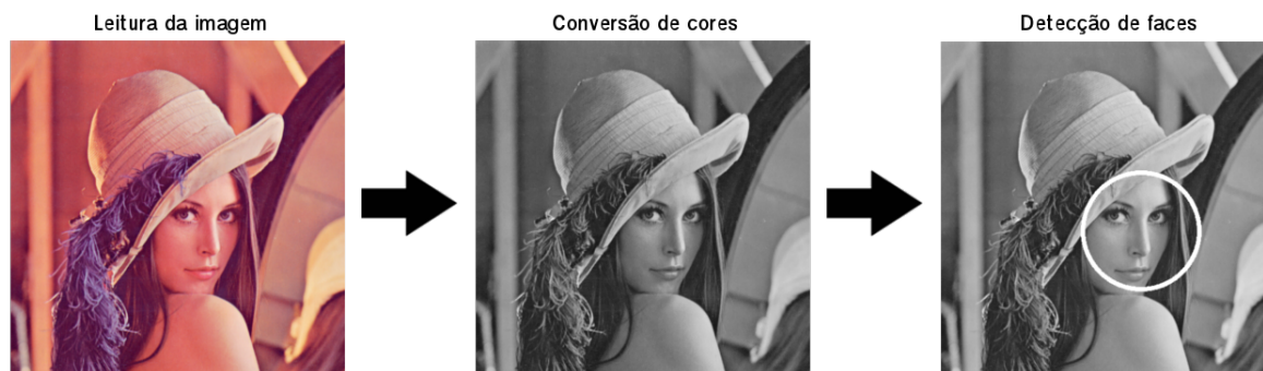
Figura 7 – Sequência de operações realizadas para detecção de faces em uma imagem.
